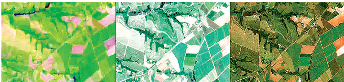
O mosaico é um retrato da mesma área de 9 km² do município de Artur Nogueira, SP, em imagens com três resoluções espaciais diferentes. Da esquerda para a direita, a primeira é do satélite Landsat 8, com pixel de 30 m; a segunda, do Sentinel 2, com 10 m; a terceira vem dos sensores de alta resolução do World View 3, com pixel de 0,30 m.
