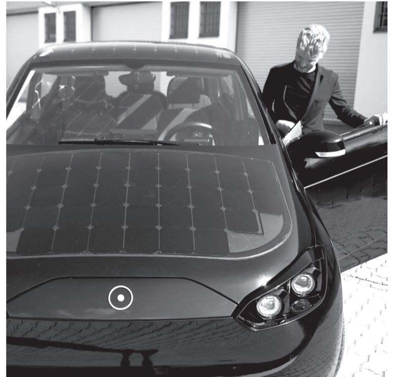
A Sono Motors, fundada em 2016, está desenvolvendo o Sion, um veículo totalmente elétrico que possui células solares integradas em sua carroceria
