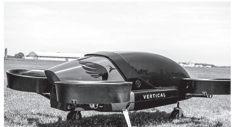
O protótipo da Vertical Aerospace é uma aeronave de eVTOL, que significa, traduzindo para o português, decolagem e pouso vertical elétricos, ou seja, que utiliza eletricidade para realizar seus movimentos
