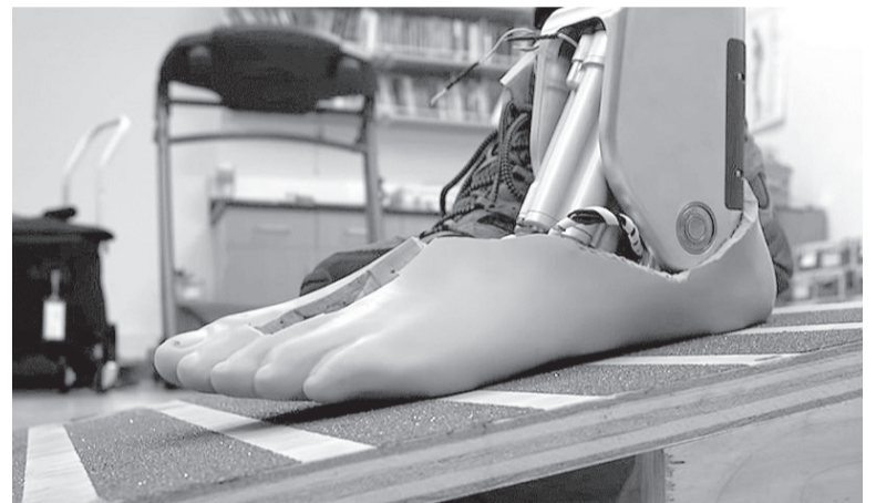
A prótese funciona de forma eficiente graças a um pequeno motor, atuador, sensores e chip que trabalham em conjunto
